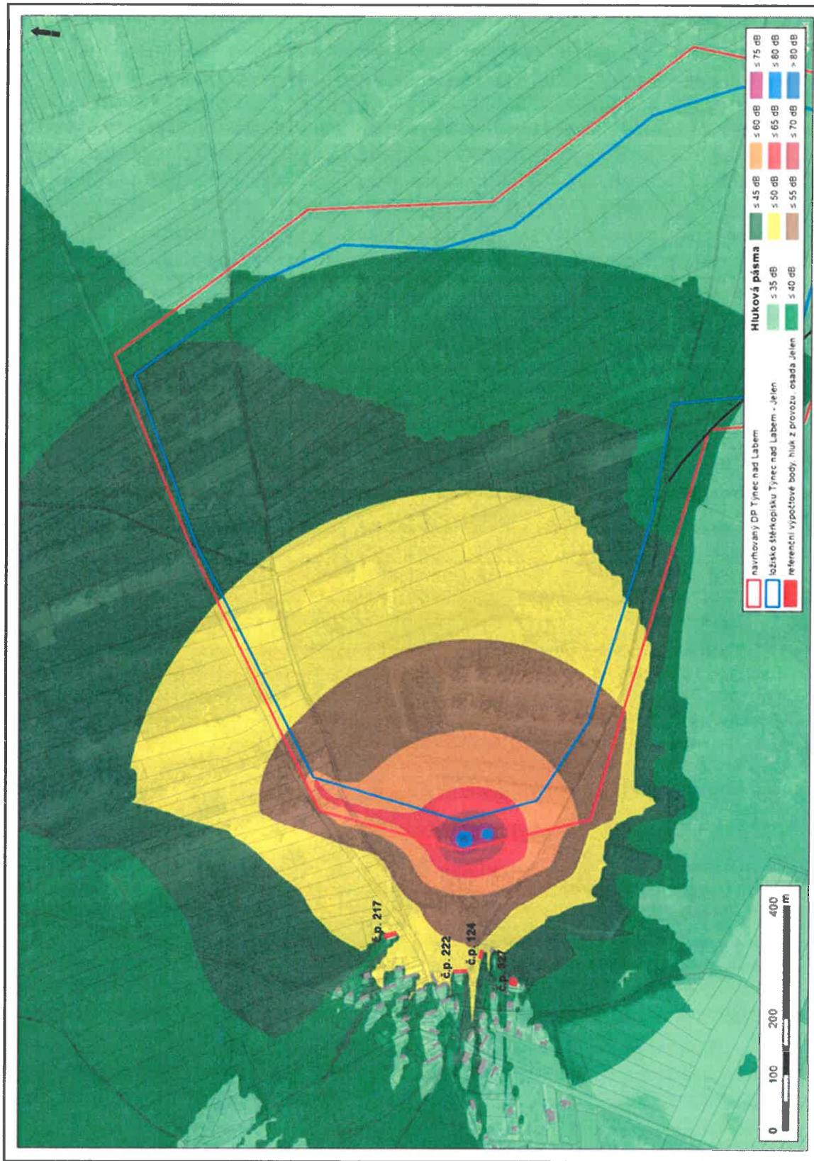
Obr. 15 Grafické rozložení hlukových pásem 2 m nad terénem - hluk z provozu, Model M1
